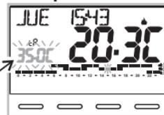
Aviso de superación del umbral configurado. La instalación de termorregulación se desactiva
