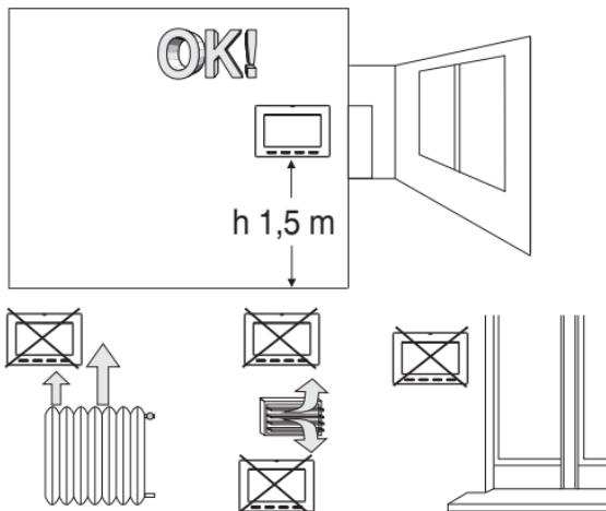
Se recomienda instalar el termostato a una altura de 1,50 a 1,60 mts del suelo, lejos de fuentes de calor, tomas de aire, puertas, ventanas o cualquier otro medio que influya en su funcionamiento.
