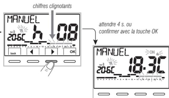
**(i)** Avec la fonction manuelle temporaire activée, il est possible de modifier le set de température autonome à une date ultérieure en appuyant sur les touches **▲▼**, ou de modifier sa durée en appuyant sur **OK** et successivement **◀▶**.
