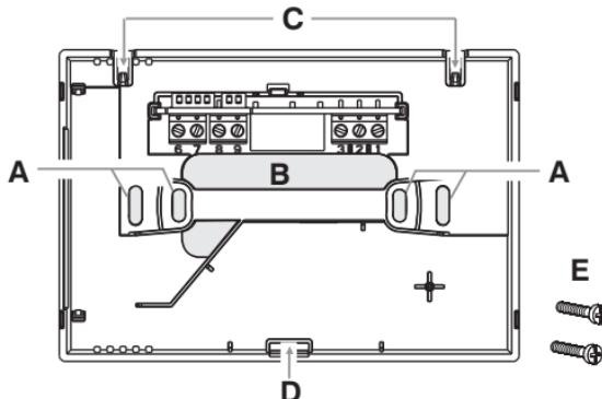
**A** - orificios de fijación de la base: de pared, caja para empotrar redonda o rectangular
