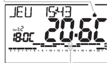
Le chiffre clignotant indique l'heure en cours qui correspond au niveau et au set de la température configuré
