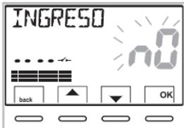
Para excluir el ingreso previamente habilitado seleccionar con las teclas **▲** **▼** la pantalla de arriba. Presione la tecla **OK** para confirmar. Presione la tecla **back** para salir.
