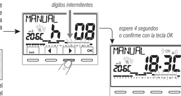
**i** Con la función de manual temporal activada, se puede cambiar el set de temperatura autónomo en otro momento, presionando las teclas **▲▼**, o su duración presionando **OK** y seguidamente **◀▶**.
