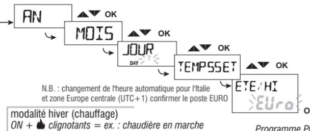
Appuyer sur les Touches **▲▼** pour modifier (pressées à impulsions, on augmente ou diminue d'une unité, en appuyant de manière prolongée, le déroulement rapide s'active).
