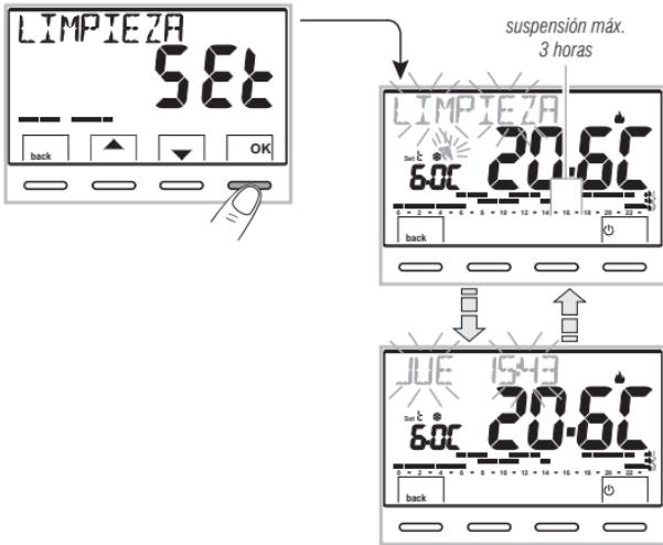
Para reactivar el programa interrumpido antes de las 3 horas, presione **back** o **OK**: desaparece el mensaje «**LIMPIEZA**».
