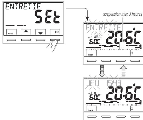
**(i)** Avec la fonction **NETTOYAGE** activée il sera possible de désactiver le thermostat programmable « **OFF** » (voir le paragraphe 10.3) en appuyant sur **OK** pendant 4 s.
