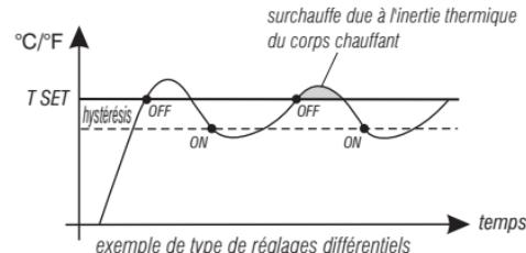
**En alternative** au différentiel thermique, il est possible de régler la température de façon **PROPORTIONNEL PAR MODULATION (PROP)**; la durée du cycle est réglable de 7 à 20 minutes (défaut 10 minutes); ce système permet de maintenir la température souhaitée plus stable, en augmentant la sensation de confort pour l'utilisateur et en économisant sur les consommations d'énergie.
