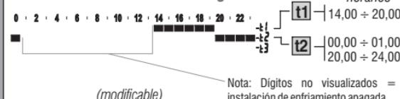
Nota: Dígitos no visualizados = instalación de enfriamiento apagada.
