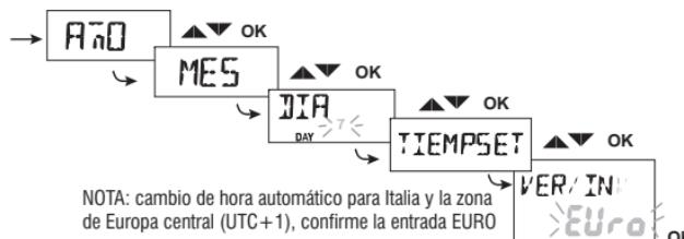
Presione las Teclas **▲▼** para realizar las modificaciones (presionadas por impulsos se aumenta o disminuye una unidad; la presión prolongada activa el desplazamiento rápido).
