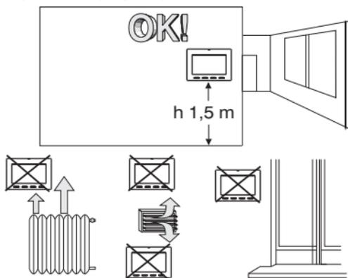
Den Uhrenthermostat vorzugsweise auf einer Höhe von 1,50 - 1,60 m vom Boden installieren - fern von Wärmequellen, Belüftungsöffnungen, Fenstern, Türen oder anderer Beeinflussung dessen Betriebs.
