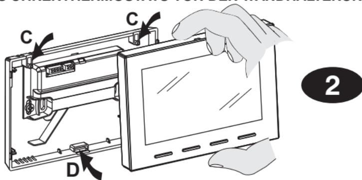
Die Uhrenthermostat an den Haken **C** an der Wandhalterung einhängen. Schließlich unten an der Uhrenthermostat drücken, damit die Befestigungsloch **D** einrastet.
