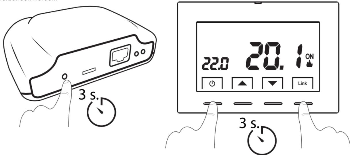
Falls am Uhrenthermostat kein Antennensymbol erscheint, sind die genannten Tasten erneut zu betätigen.
