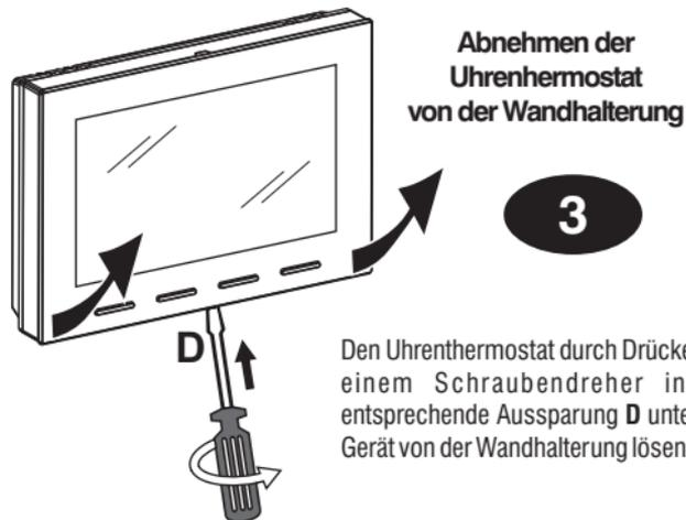
Den Uhrenthermostat durch Drücken mit einem Schraubendreher in die entsprechende Aussparung **D** unten am Gerät von der Wandhalterung lösen.
