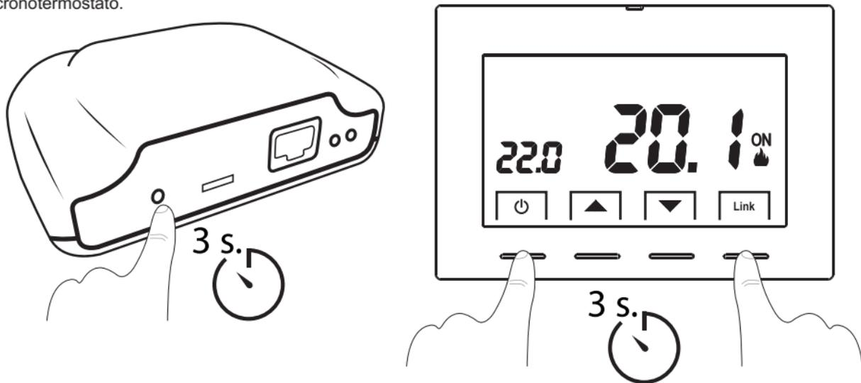
Si en la pantalla del cronotermostato no aparece ningún símbolo antena, repita la operación de arriba.
