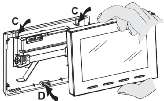
Enganche el cronotermostato en la base de pared, concretamente en los dientes C. Después, presione el termostato inferior hasta completar la fijación en la ranura D.
