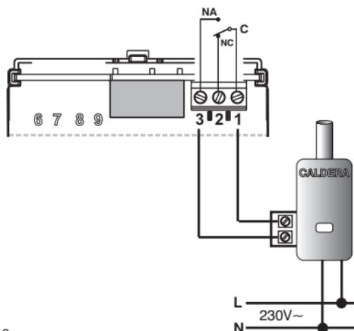
*Conexión a una válvula motorizada*
