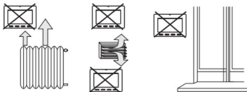
Se recomienda instalar el termostato a una altura de 1,50 a 1,60 mts del suelo, lejos de fuentes de calor, tomas de aire, puertas, ventanas o cualquier otro medio que influya en su funcionamiento.
