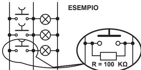
Il funzionamento del temporizzatore è subordinato all'allacciamento di un carico minimo (neon 40W - elettronico 16W - incandescenza 10W) in quanto **in assenza di carico il prodotto non funziona.**
