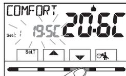
In presenza di blocchi per la temperatura max e min. (vedere paragrafo 11.6) non si potrà impostare un Set t superiore o inferiore ai blocchi inseriti. Il display segnalerà l'impossibilità ad eseguire il comando visualizzando la scritta **BLOCCO**.
